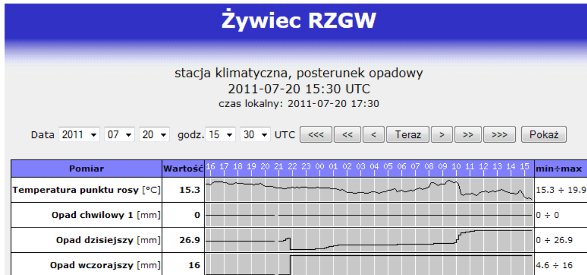
Rysunek 4: Błędne wyświetlanie wartości opadu chwilowego dla stacji Żywiec RZGW w dniu 20.07.2011 (źródło: http://www.traxelektronik.pl/pogoda/zywiec/ )
