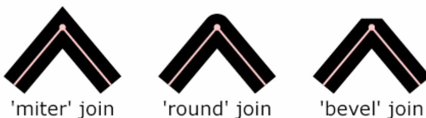
Rys. 2.24. Rodzaje łączeń linii. [Źródło: http://www.w3.org ].
