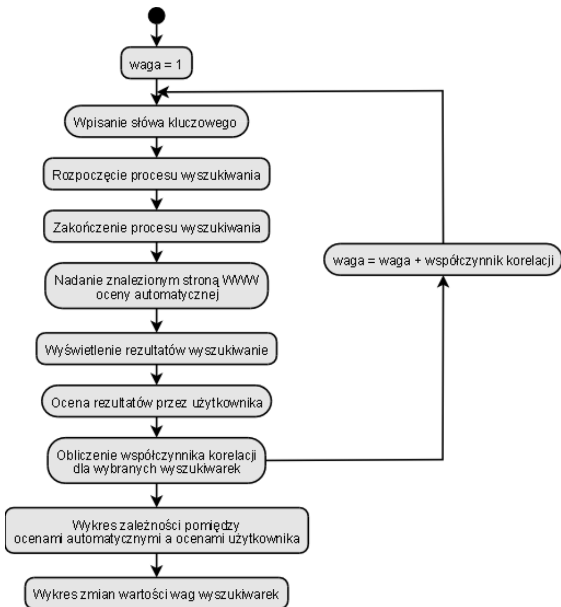
Rys. 14. Schemat blokowy działania systemu SEP.
